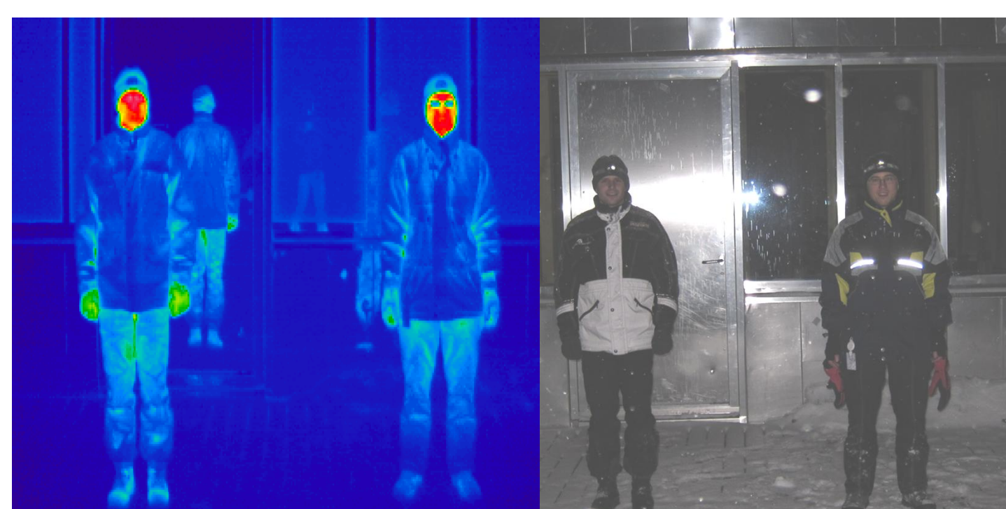
Abbildung 3: Spiegelung an der Aluminium-Fassade
