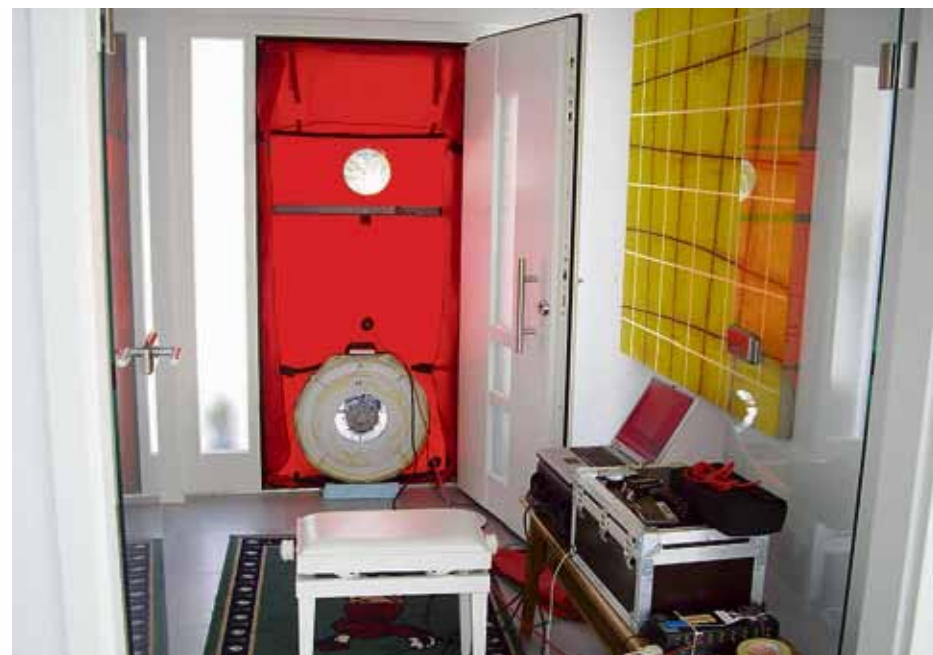
In der Haustür eingebaute Messeinrichtung, eine sog. BlowerDoor-Anlage. BILDER C. TANNER
