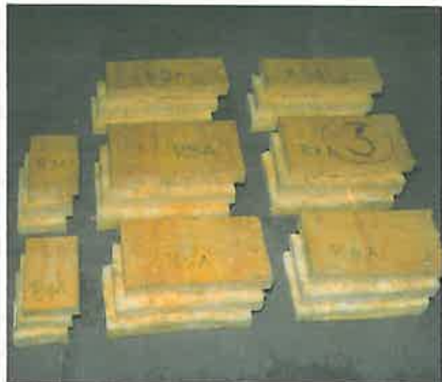
Bild 2 Aus den berieselten Dämmstoffplatten wurden Prüfkörper herausgeschnitten, woran gravimetrisch der Feuchtegehalt in Massen-% bestimmt wurde.
