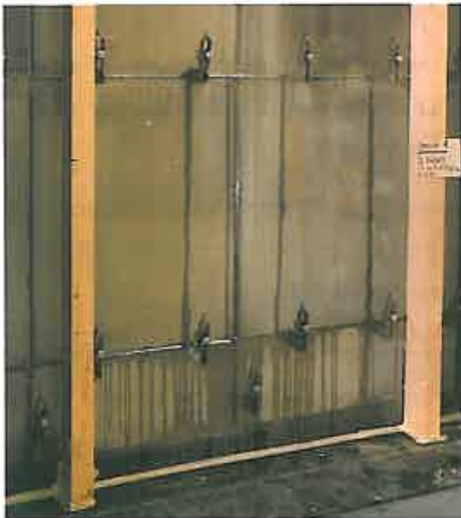
Bild 10 Nach kurzer Zeit fließt Wasser auf den Fassaden- platten-Rückseiten ab.
